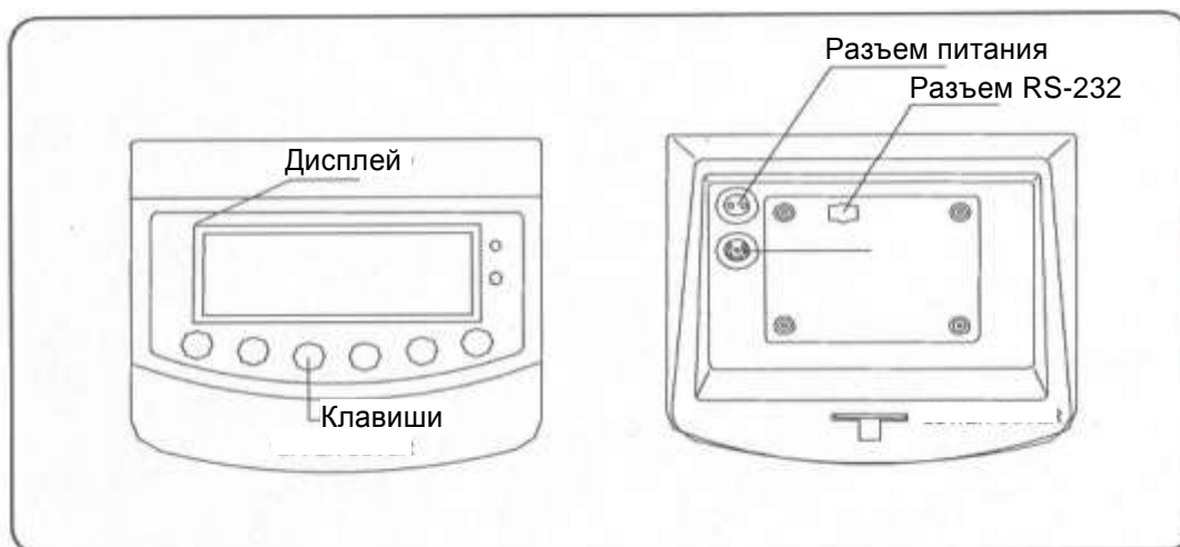
Рисунок 4.2 - Общий вид лицевой и задней панели, расположение и обозначение их основных элементов
